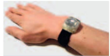
Dieses Gerät misst sämtliche Armbewegungen, auch Veränderungen im Laufe der Therapie.
